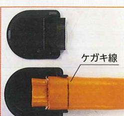
※本工程で左写真のようなケガキ線をいれておくと、端末処理ケースからヒーターが飛び出していくかを確認することが容易になります。
