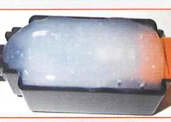
③電源接続ケースに、2液混合したシーリング材を注入します。
