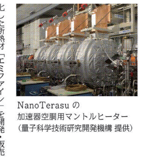
NanoTerasuの加速器空調用マントルヒーター(量子科学技術研究開発機構提供)
